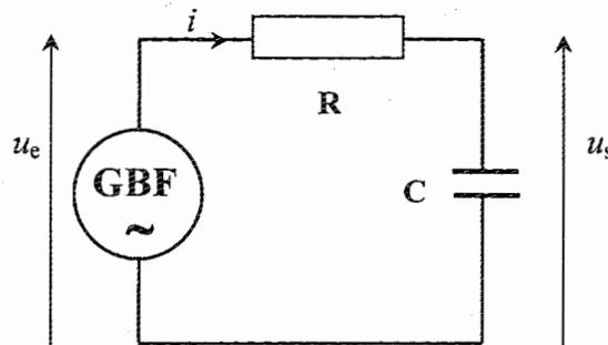
On note :  $u_e$ , la tension d'entrée sinusoïdale,
