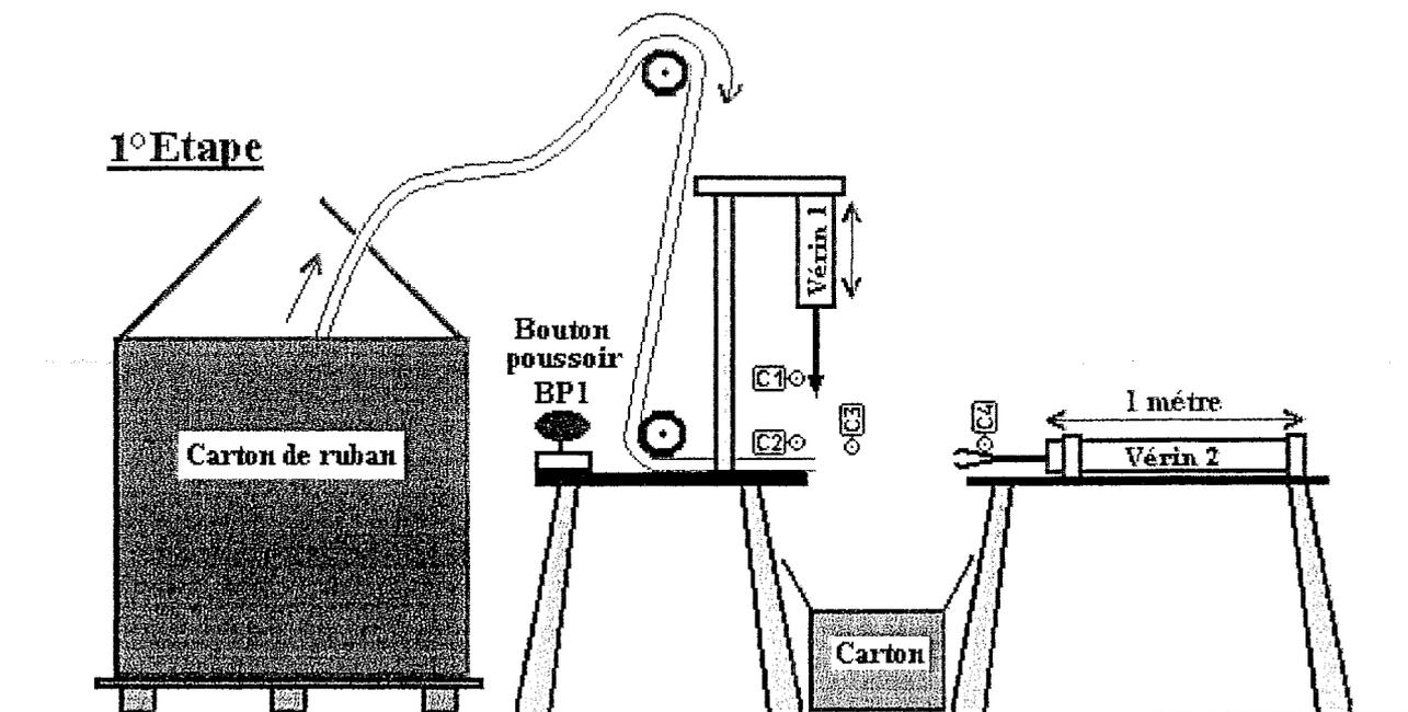
Le système semi-automatique est en attente de départ du cycle. Le vérin 1 équipé d'une lame coupante est en position rentré. Le capteur C1 est enclenché. Le vérin 2 équipé d'une paire de pince est également en position rentré. Le capteur C4 est enclenché.
