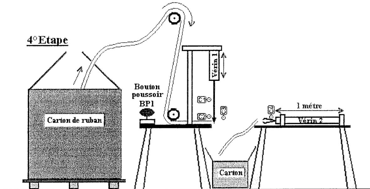
Le vérin 1 sort et la lame coupe le ruban. Le capteur C2 est enclenché. Le ruban d'un mètre tombe dans le carton.
