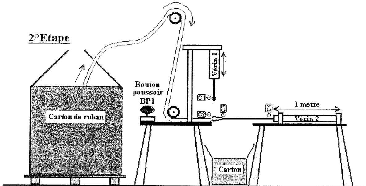
Un opérateur appuie sur le bouton BP1 et le cycle opératoire est lancé. Le vérin 2 sort pour pincer le ruban. Le capteur C3 est enclenché.
