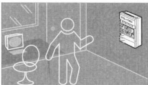
Signalisation sonore et visuelle locale
