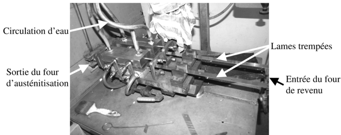
Bloc de refroidissement pour la trempe des lames
