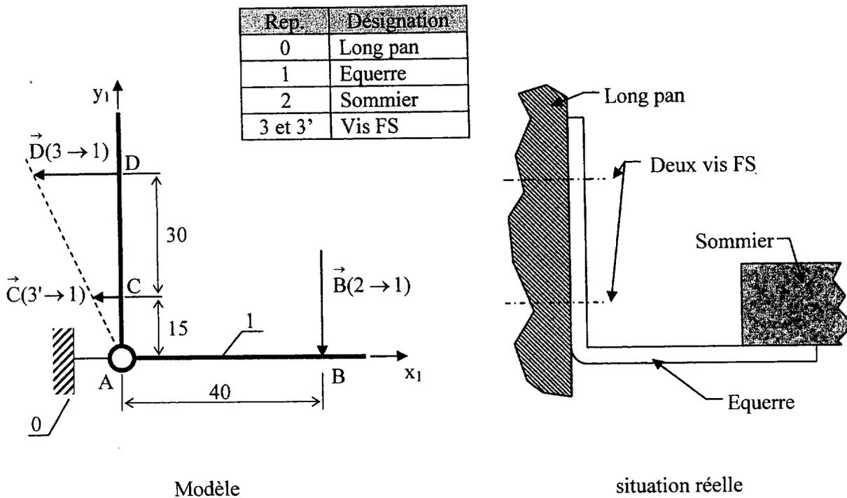
La charge appliquée par le sommier sur le lit correspond au cas défavorable de l'étude précédente. Cette action mécanique est réduite à une action mécanique concentrée  $\vec{B}(2/1)$  appliqué en B et de norme : 850 N.
