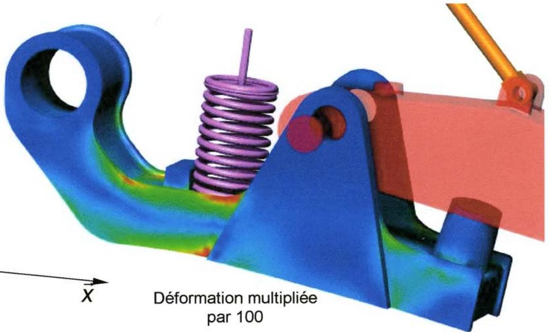
Simulation de fin de descente ( $t = 0$  juste avant impact de la faucheuse sur le sol / impact à  $t = 0,09$  s)
