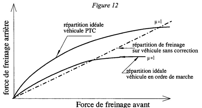
Les systèmes mécaniques ne permettent pas d'obtenir une parabole ; d'autre part la réglementation impose que la répartition réelle se situe sous la parabole, dans le domaine  $0,2 \leq \mu \leq 0,8$  afin d'avoir une prépondérance de blocage de l'essieu avant, tout en respectant une décélération la plus grande possible.
