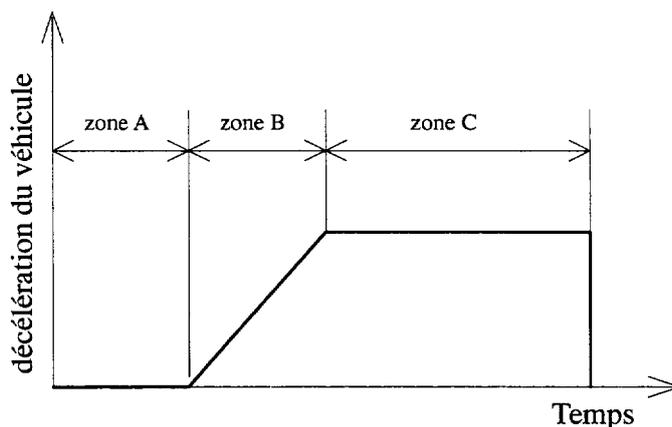
zone A : temps de réaction du conducteur
