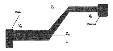
A partir de l'équation de Bernoulli, calculer la vitesse  $v_B$  d'écoulement du liquide frein de la pompe au réservoir. Arrondir le résultat à l'unité.
