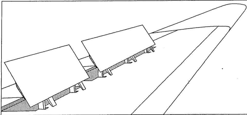
On considère un aérofrein actionné par un vérin. Sa surface peut être modélisée par un rectangle de largeur 700 mm et de longueur 2 000 mm. Son fonctionnement est donné par le schéma ci-dessous :
