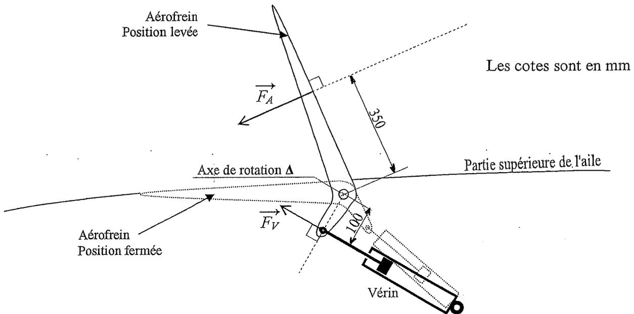
En position levée, la force pressante de l'air, répartie sur toute la surface du volet, est équivalente à une force unique  $\vec{F}_A$  de direction perpendiculaire à la surface du volet.
