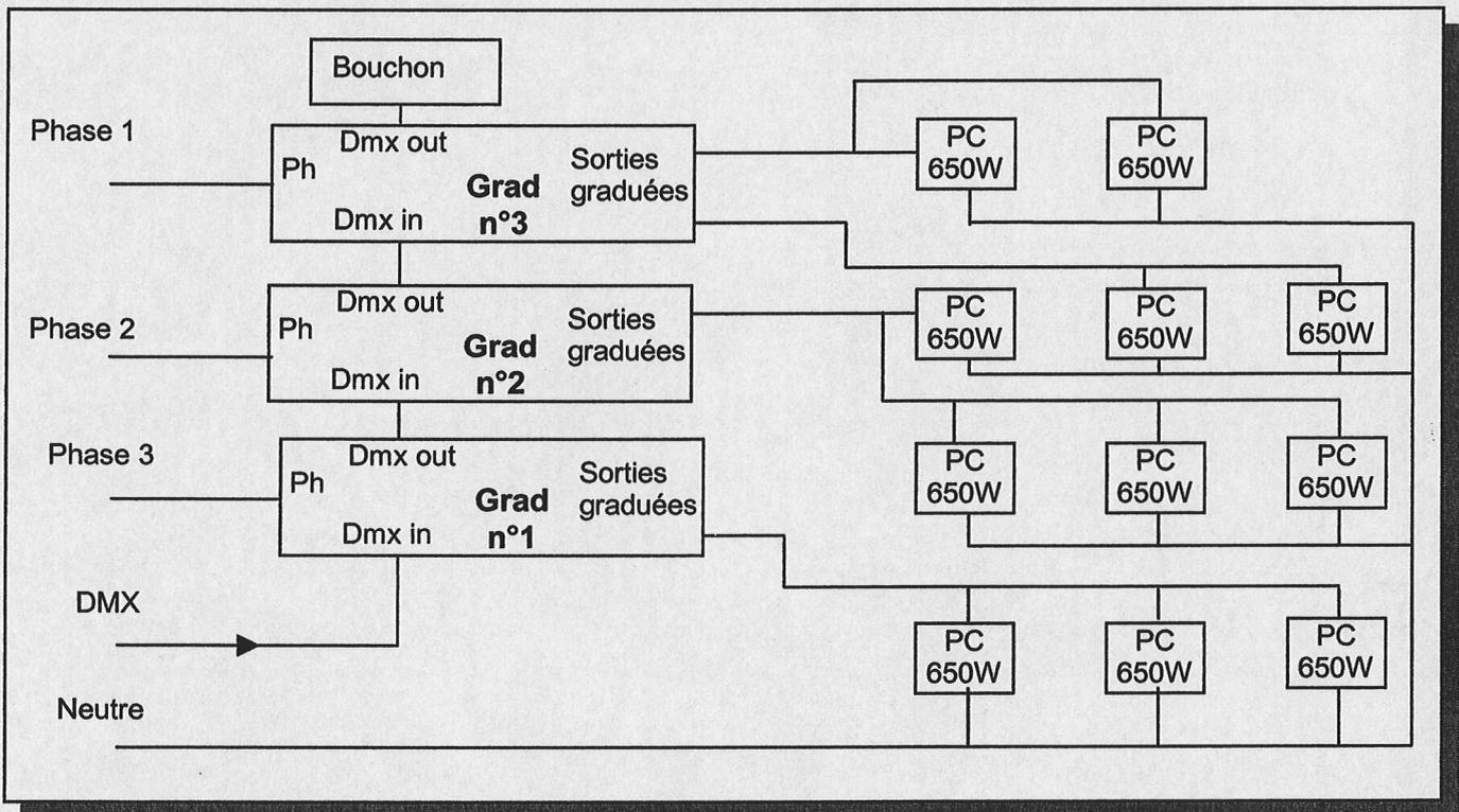
6.1.1 Compléter, sur le schéma précédent, le câblage des projecteurs, en limitant au maximum le déséquilibre des phases.
