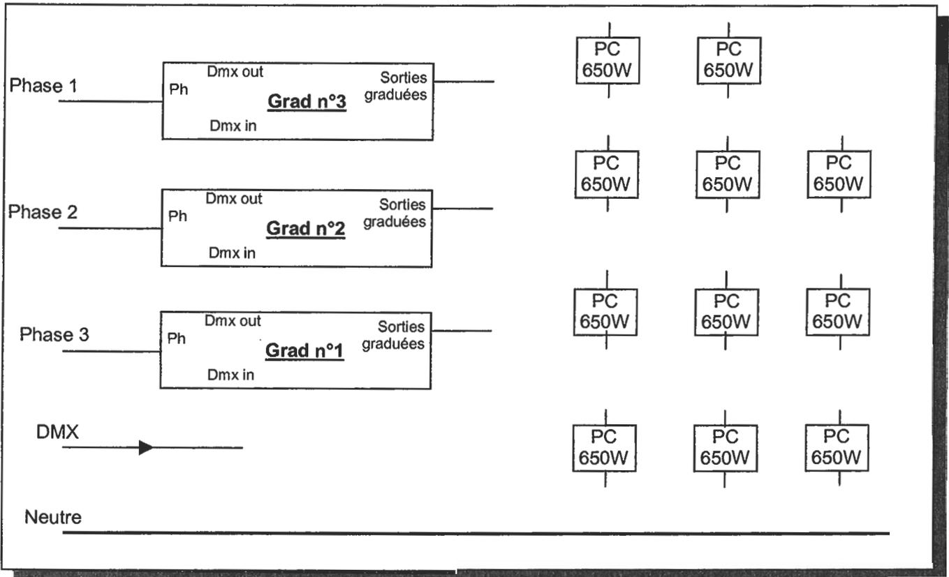
6.1.1 Compléter, sur le schéma précédent, le câblage des projecteurs, en limitant au maximum le déséquilibre des phases.
