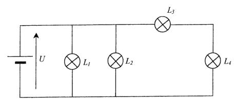
Les 4 lampes  $L_1$ ,  $L_2$ ,  $L_3$  et  $L_4$  sont identiques et ont pour puissance P = 6 W.
