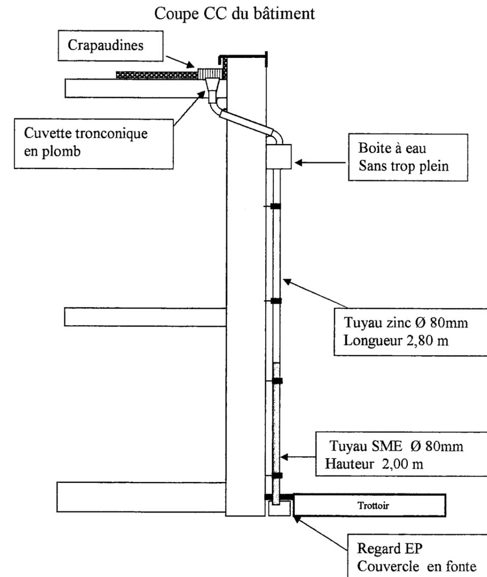
**Dimension du diamètre intérieur d'un tuyau d'évacuation des eaux pluviales**
