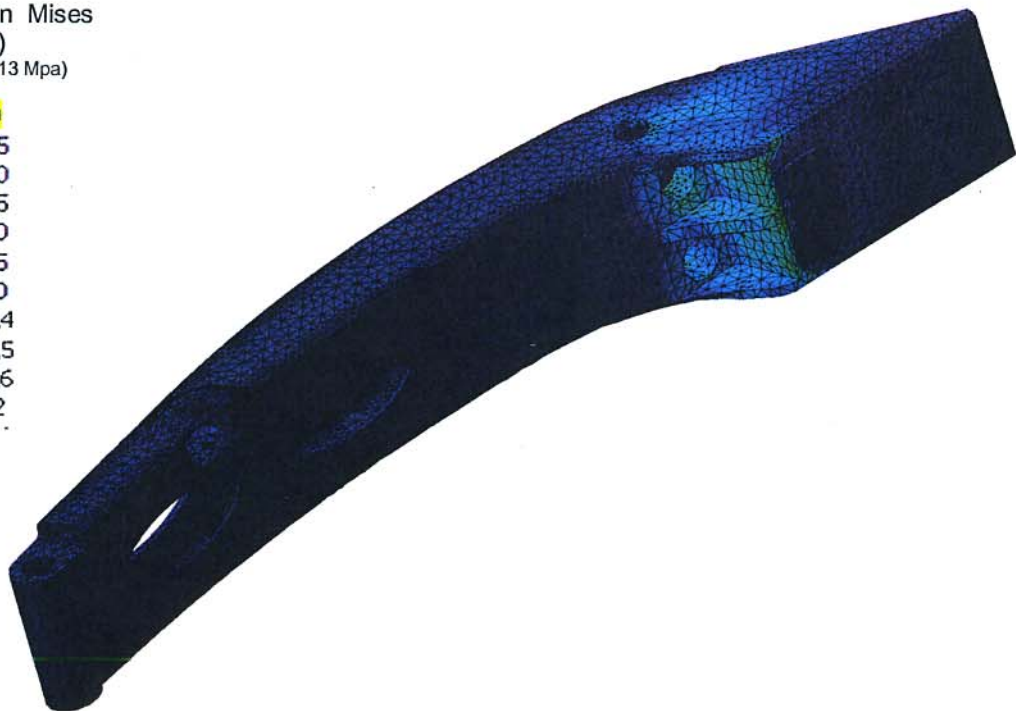
Analyse par éléments finis d'un bras de la pince CB15
