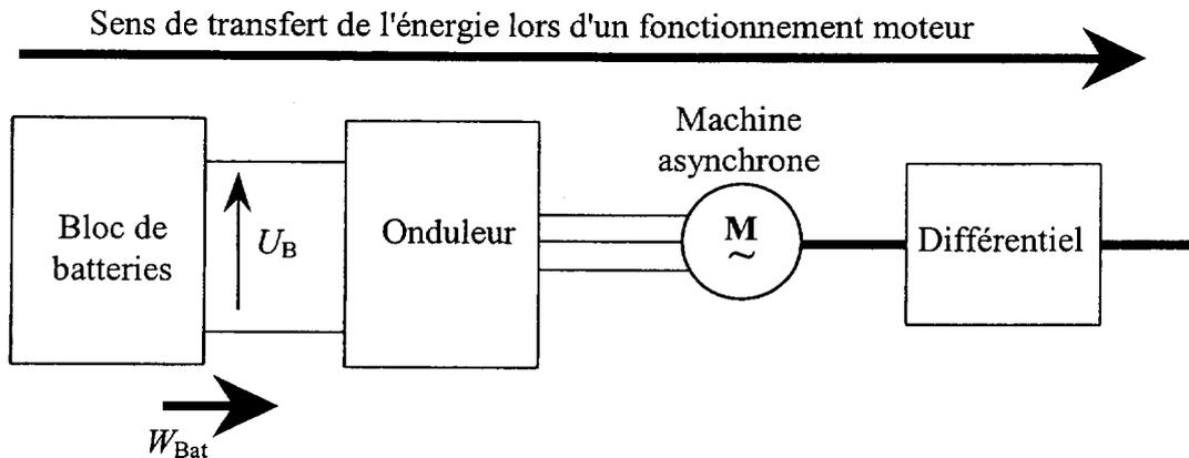
Les véhicules électriques ne possèdent pas de boîte de vitesse. Le moteur asynchrone alimente directement le différentiel.
