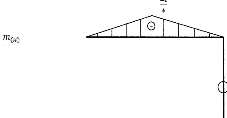
$$\Delta_{T_{AB}} = \frac{l}{EI} \frac{1}{l} \int_{AB} M m ds + \frac{2l}{3EI} \frac{1}{\frac{2l}{3}} \int_{BC} M m ds = \frac{l}{EI} \left[ \frac{5}{12} \left( \frac{-ql^2}{8} \right) \left( \frac{-l}{4} \right) \right] = \frac{5ql^4}{384EI} \text{ vers le haut (}\uparrow\text{)}$$
