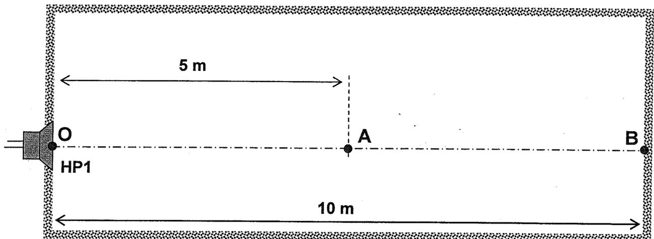
Le niveau acoustique mesuré à 1 m du haut-parleur HP1, sur son axe, est 96 dBspl lorsqu'on lui fournit une puissance électrique de 1 W. L'onde sonore produite est sinusoïdale de fréquence 425 Hz.
