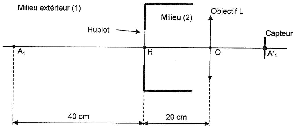
1 - À terre, on essaie la caméra placée dans un camion. Le milieu extérieur (1), comme le milieu (2) (intérieur du caisson), sont de l'air.
