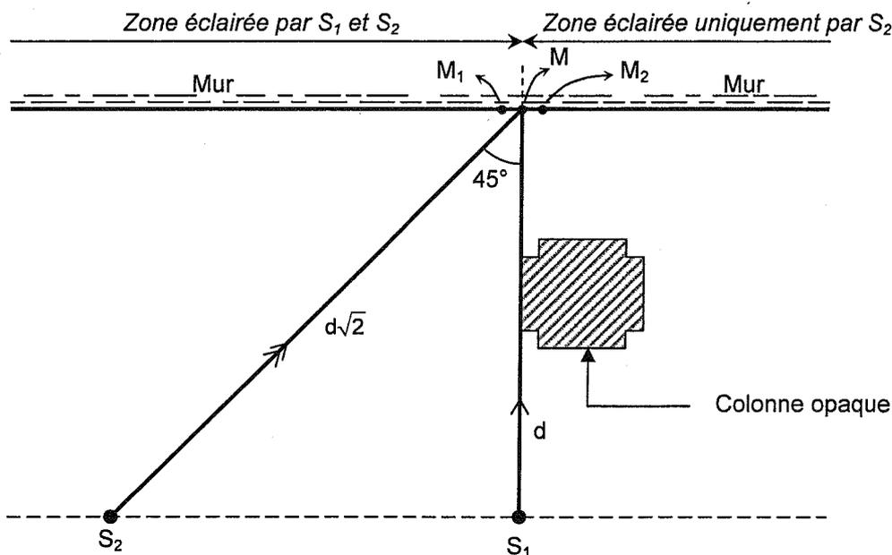
La droite  $(S_1S_2)$  est parallèle au mur. Les droites  $(S_1M)$  et  $(S_2M)$  sont respectivement les axes principaux des sources  $S_1$  et  $S_2$ .
