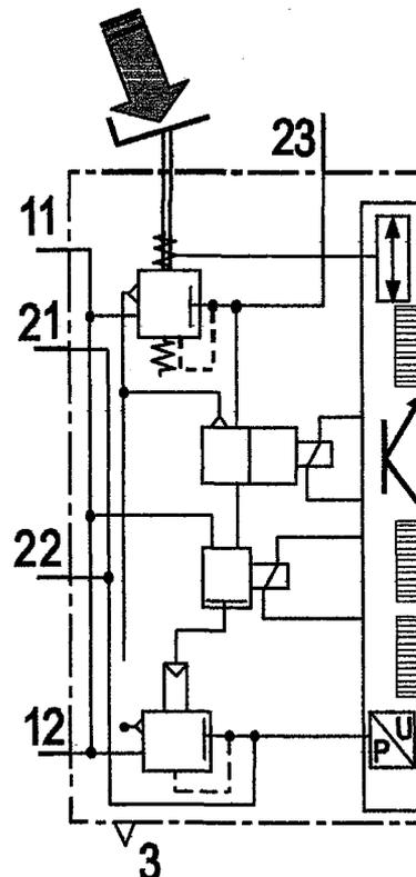
**5.3 - Régulation de la pression délivrée par la CBU aux orifices 21 et 22 en mode freinage normal :**
