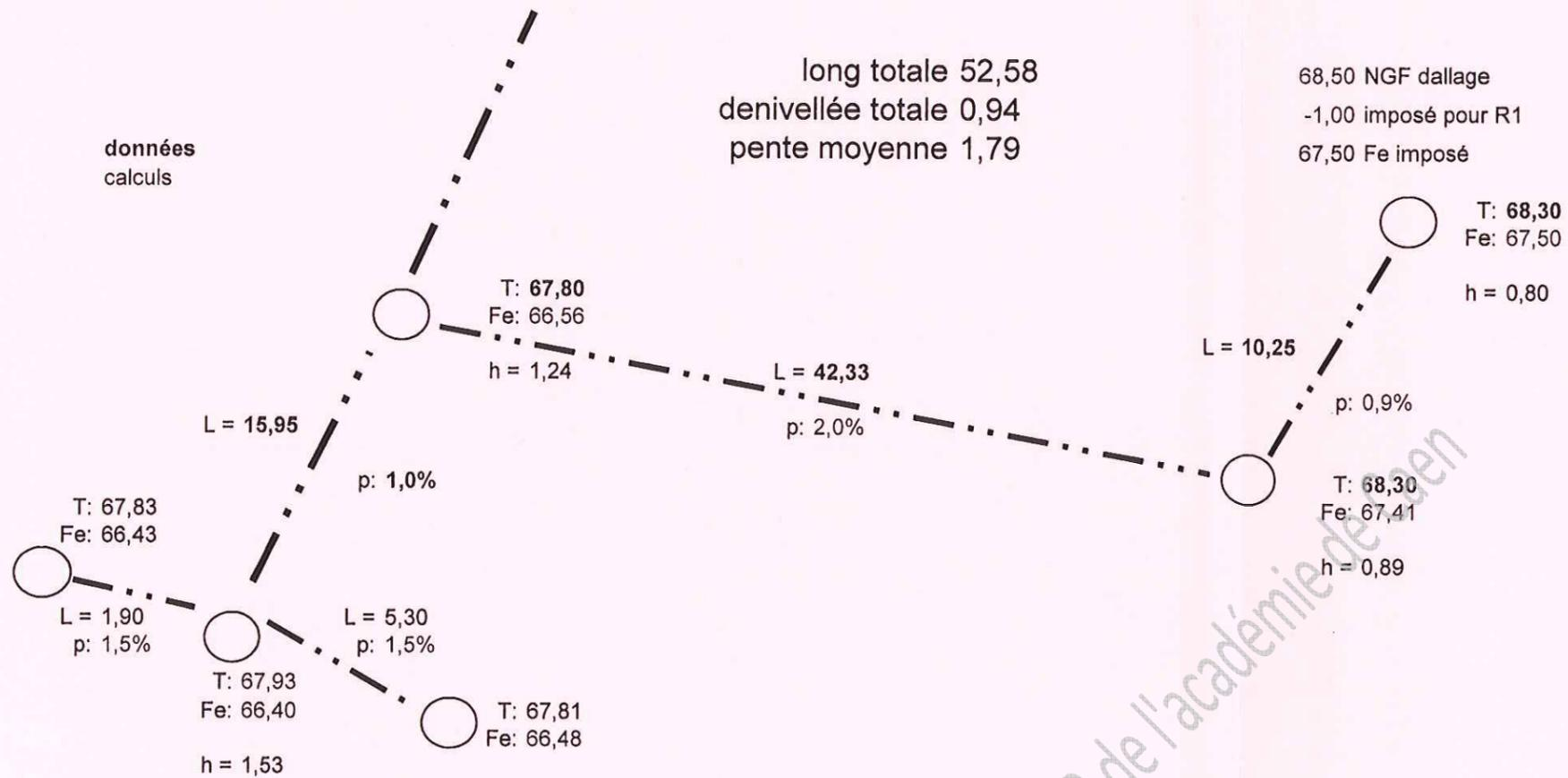
**Conclusion :** la pente de 0.9% est inférieure à la pente minimale donc elle ne suffit pas.
