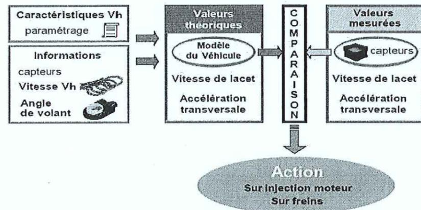
Le calculateur compare les valeurs théoriques (modèle du véhicule) aux valeurs fournies par les capteurs de lacet et d'accélération transversale, et détermine alors les actions à appliquer :
