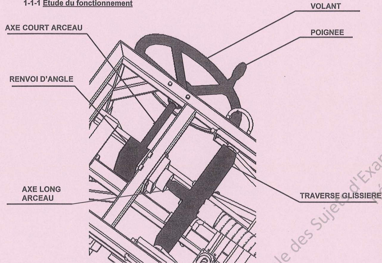
Pour effectuer la montée de la nacelle, l'opérateur agit sur la poignée du volant.
