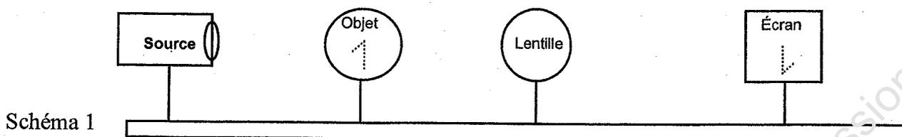
Pour mesurer la distance focale d'une lentille, on utilise le montage optique représenté ci-dessus.
