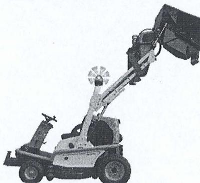
Le déplacement de la clape est obtenu par deux vérins double effet.
