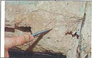
Tester la **dureté** de la pierre saine avec un outil métallique (pointe, tournevis...) par un mouvement linéaire appuyé. Il est possible de rencontrer des pierres de duretés différentes sur une même façade, aussi faut-il réaliser le test en plusieurs endroits.
