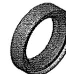
Etanchéité statique : les pièces, entre lesquelles est réalisée l'étanchéité, sont immobiles l'une par rapport à l'autre.
