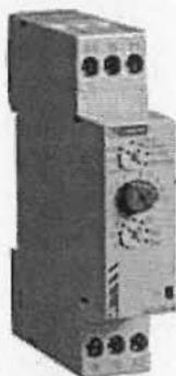
Un relais temporisé est un appareil d'automatisme qui permet à l'issue d'un temps préalablement déterminé, de transmettre une information électrique. On l'appelle aussi relais tout ou rien à temps spécifié ou encore minuterie.
