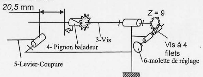
La position des 2 pignons baladeurs est réglée en usine au milieu de la vis (3), la course utile du pignon baladeur est de 20,5 mm.
