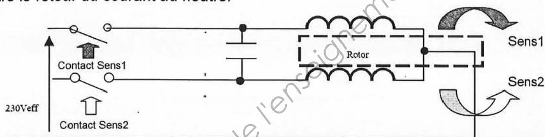
Pour tourner dans un sens ou dans l'autre, le moteur doit être alimenté sur une seule bobine à partir de la fermeture d'un des deux contacts. La bobine alimentée directement génère un champ en phase avec le secteur, l'autre bobine est alimentée via le condensateur qui se trouve en série avec elle et générant un déphasage de la tension par rapport au courant. Les moteurs SOMFY sont très faiblement inductifs, les bobines n'ont donc que peu d'effet sur le déphasage  $U - I$ .
