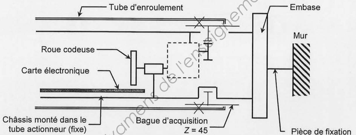
La solution adoptée repose sur une roue magnétique, se trouvant à la sortie d'un train d'engrenages entraîné en rotation par le tube d'enroulement via la bague d'acquisition.
