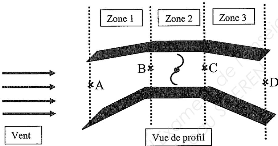
La section à l'entrée de la zone 1 est assimilable à un rectangle de surface  $S_1 = 1,35 \text{ m}^2$ .
