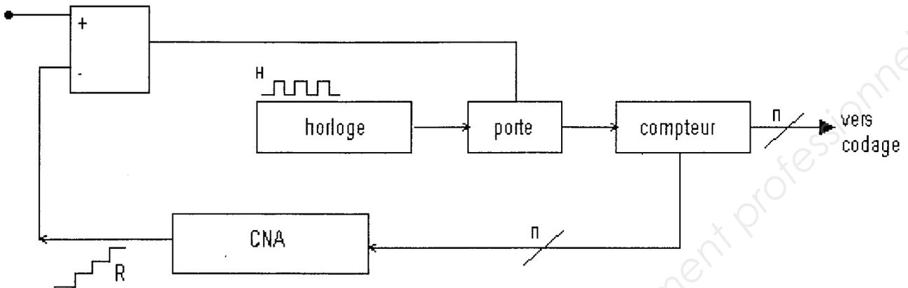
Tant que la tension R (résultat) est inférieure à E (Entrée), la sortie de l'ampli est positive.
