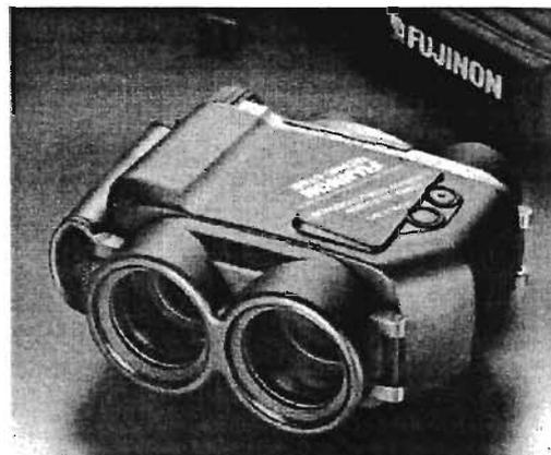
L'innovation technologique consiste dans le fait que les prismes sont sur des supports mobiles, déplaçables à très haute vitesse par deux servomoteurs, l'un assurant la compensation horizontale (AZ) et l'autre la compensation verticale (EL). Chacun de ces moteurs est contrôlé numériquement par l'association de capteurs de vibrations et de position.
