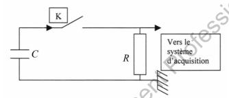
À l'instant t = 0 s, on ferme l'interrupteur K. Un système d'acquisition permet d'enregistrer pendant 4 heures l'évolution de la tension aux bornes du condensateur en fonction du temps. La courbe obtenue est représentée sur le document 5 page 9 en annexe à rendre avec la copie.
