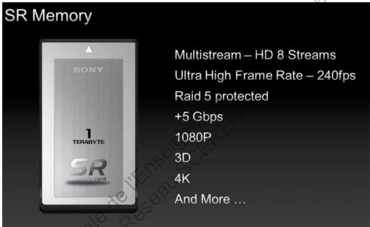
Nouveau support mémoire solid state de 1 Teraoctets à débit de 5 Gbit/s garanti pour les flux les plus élevés du HDCAM SR 2K et futur 4K. Composé de multiples modules mémoires rapide, en architecture RAID 5.
