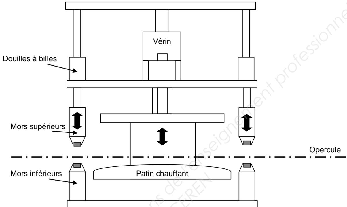
Le système d'étirage est composé de deux pinces et d'un Patin chauffant. Après le premier coup de soudure, la mise au pas de l'opercule par rapport au pas machine est prise en charge par le système d'étirage à chaud.
