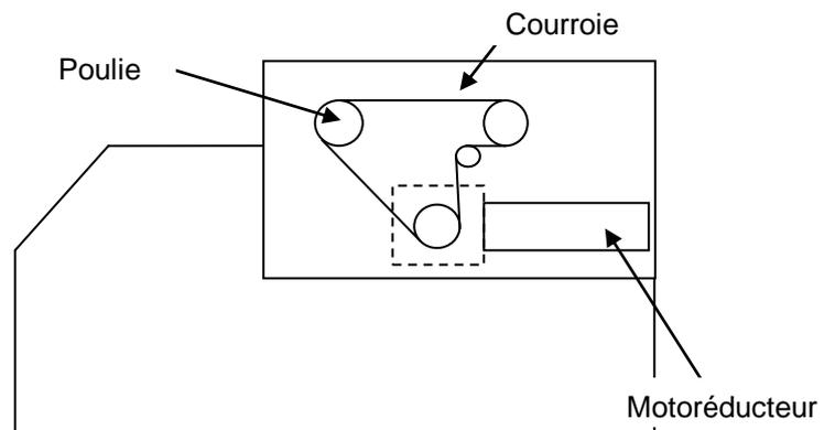
Le déroulement des bobines est assisté par un motoréducteur. Lorsque les chaînes sont arrêtées, le motoréducteur entraîne la bobine jusqu'à détection par le détecteur du bras de tension en position basse. Quand les chaînes avancent, l'opercule est tiré, le bras de tension remonte. Une seule bobine peut être assistée au déroulement.
