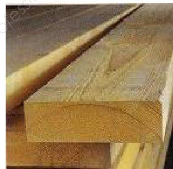
Solive : section : 75 X 225 mm longueur : de 3 à 6 m.
