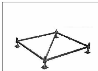
2 Pose des traverses de base, de la diagonale et mise à niveau.
