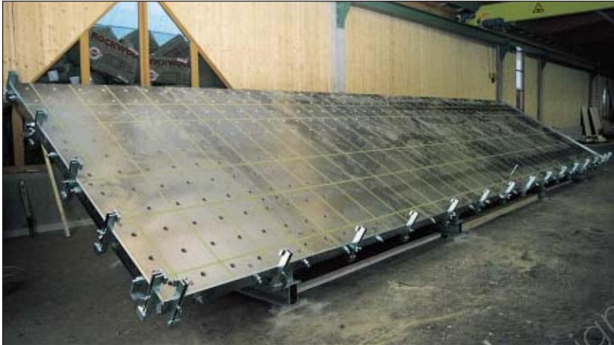
Grâce au système modulable très flexible il y a la possibilité d'ajouter une inclinaison hydraulique à la table de montage. La charge utile de la table est de 140 kg/m<sup>2</sup> au minimum .
