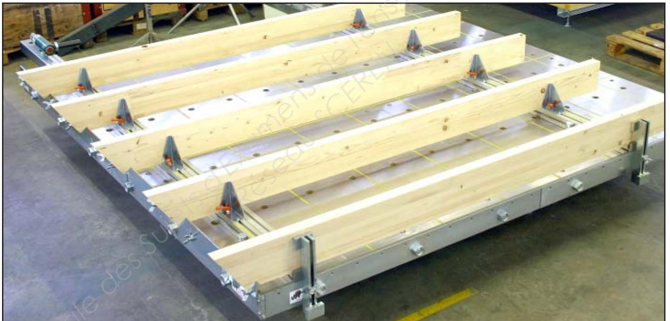
Deux rails spéciaux munis de butées réglables sont fixés sur la table à l'aide de la grille à trous. L'écart des butées réglables est défini une fois pour plusieurs ossatures.
