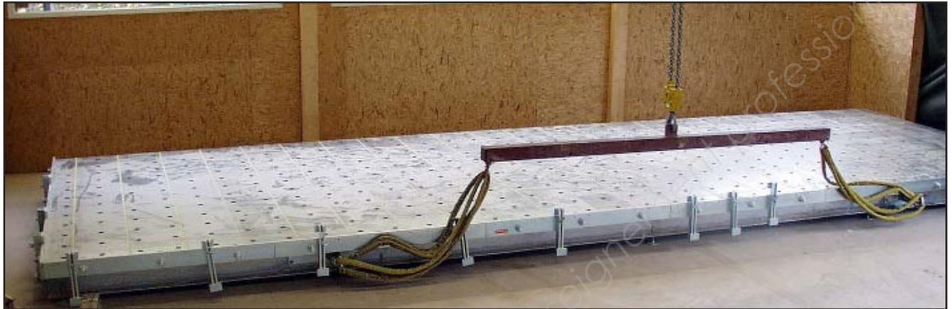
A cet effet les modules sont montés sur un châssis spécial qui garantit la stabilité et la précision de la table malgré de grands forces de torsion.
