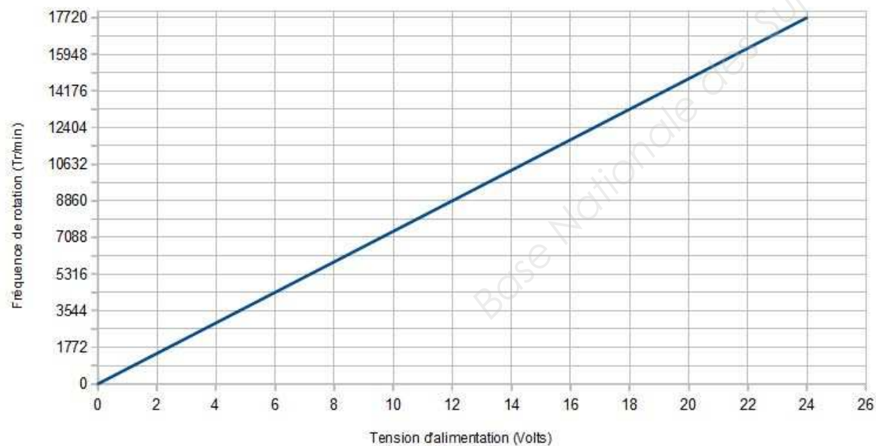
Evolution de la fréquence de rotation en fonction de la tension d'alimentation
