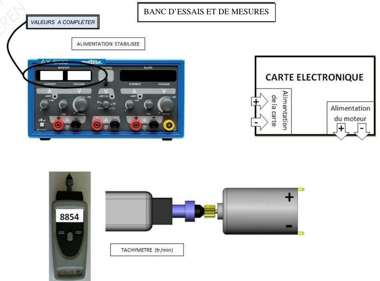
Relever la valeur constructeur et la valeur mesurée de la fréquence de rotation en fonction de la tension à l'aide de la fiche technique du moteur **DT5/8**.
