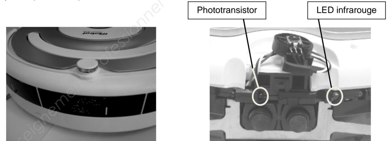
Indiquer sur le croquis ci-dessous, à l'aide de **flèches**, le trajet du rayon infrarouge de la diode émettrice à la diode réceptrice, pour détecter un obstacle, en prenant l'axe moyen du faisceau.
