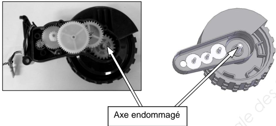
Pour le démontage de l'axe, il est nécessaire de réaliser un outillage spécifique permettant son démontage sans endommager le sous-ensemble **DT5/8**.
