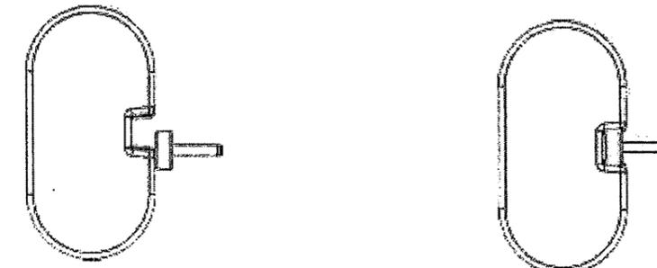
Pour remplir correctement sa fonction, le centreur doit pouvoir coulisser dans le montage et revenir en position à l'aide d'un ressort.
