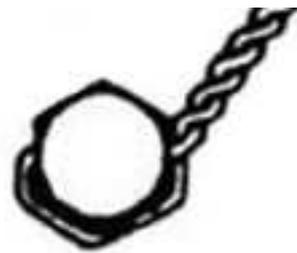
**Q12.4** Pour fixer la pièce de maintien de la jambe de train, on serre les 3 vis (à pas à droite) suivantes au couple, et on les freine au fil à freiner.
