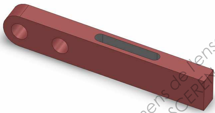
Figure 2 : Levier usiné. Matériau : Acier 35 Cr Mo 4 ; Re = 770 \text{ MPa}
