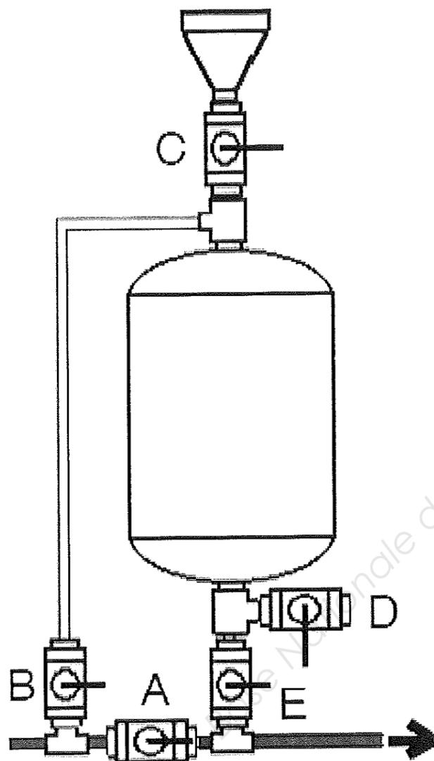
Schéma de principe d'un pot d'injection
