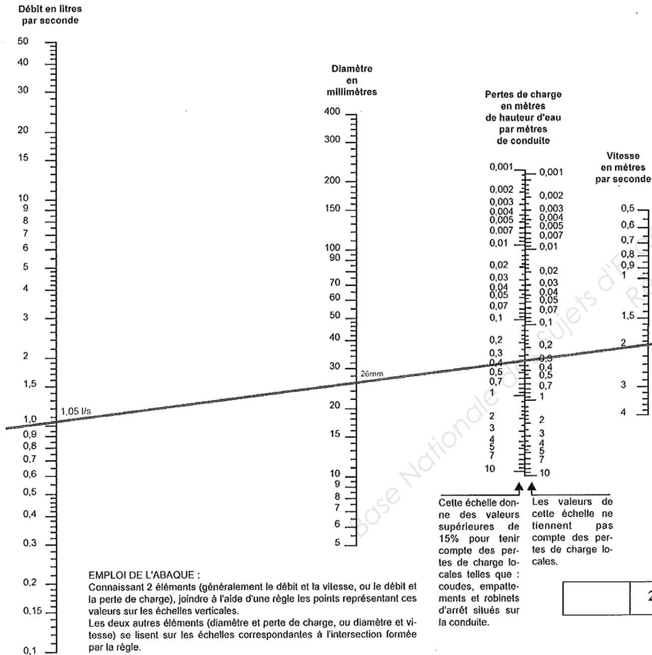
2.3/ Tracer sur l'abaque de Dariès la représentation de l'écoulement dans le tube
