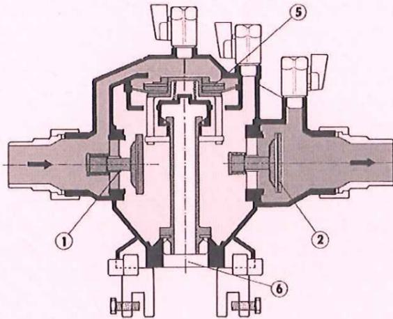
La soupape de décharge reste fermée, les clapets amont et aval sont ouverts permettant l'écoulement de l'eau à travers l'appareil.
