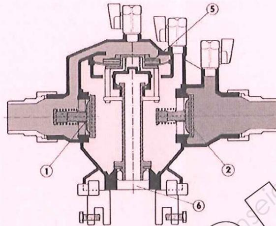
Le disconnecteur est sous pression, il y a arrêt de débit ; les clapets amont 1 et aval 2 se ferment, la soupape de décharge reste fermée sous l'action de la pression différentielle sur la membrane.
