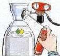
Testez l'étanchéité avec le détecteur "1000 Bulles".
