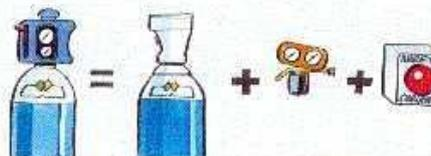
Altop, c'est la bouteille + 1 détendeur + 1 arrêt d'urgence.
