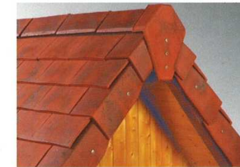
Emploi des rives individuelles gauches et droites. Fixation du fronton par vis et rondelle d'étanchéité.
