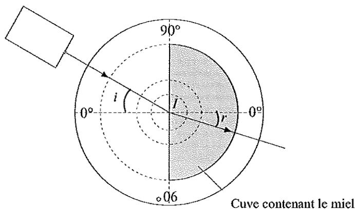
On fait varier la valeur de l'angle d'incidence  $i$  et on mesure sur le disque gradué la valeur de l'angle de réfraction  $r$  correspondant.
