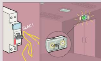
3-Coupure de l'éclairage normal, allumage des BAES (fonctionnement en sécurité)
