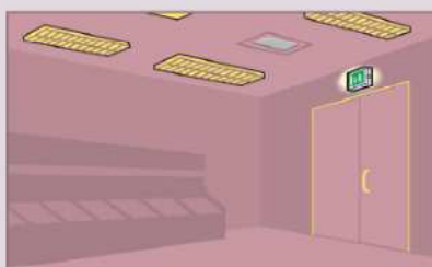
2-Fin de l'exploitation de l'établissement. Absence du public (éclairage normal allumé - BAES en veille)
