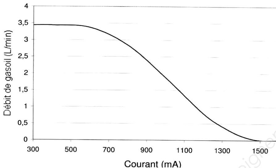
**Electriquement** : Comme nous pouvons le constater sur le schéma, l'électrovanne de dosage est passante lorsqu'elle n'est pas alimentée, laissant ainsi passer la totalité du gasoil. Cela entraîne une montée en pression maximum dans le rail.
