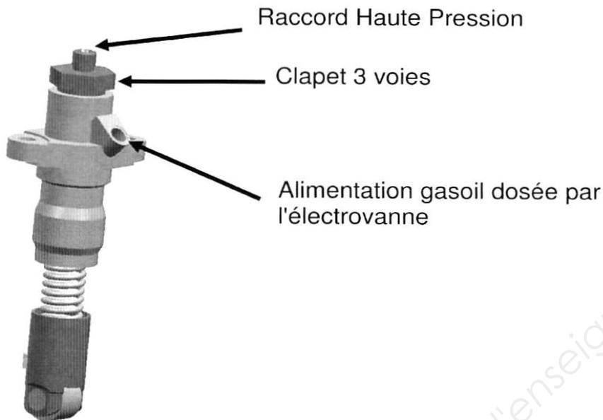
Le clapet 3 voies assure 2 fonctions :
