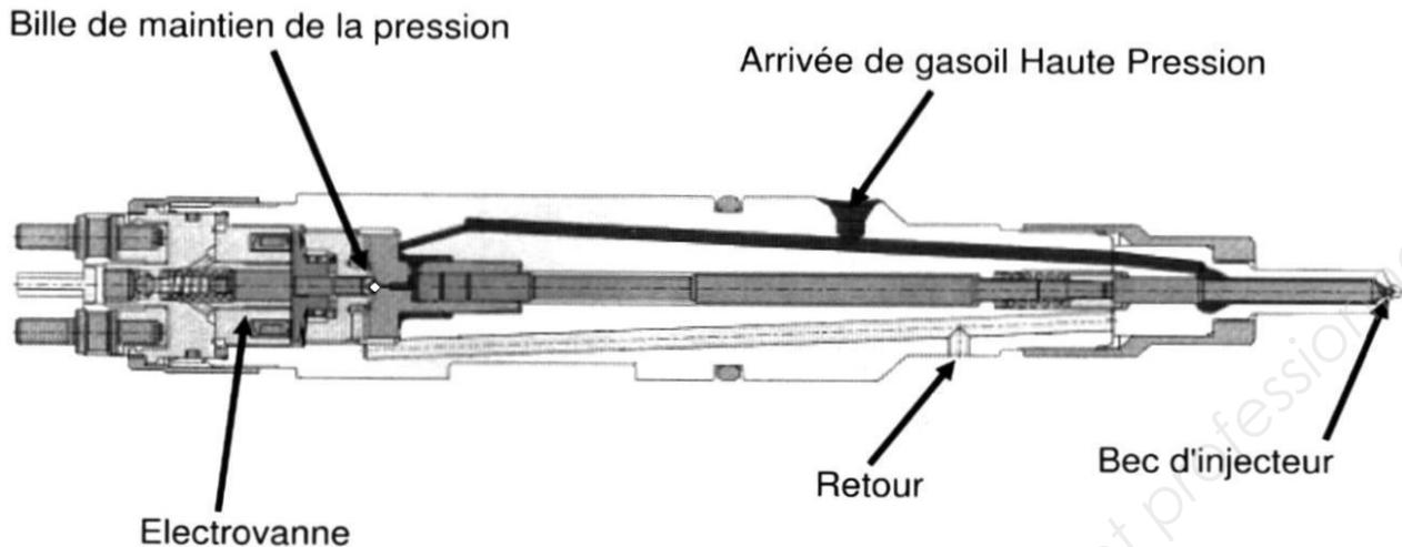
Nous voyons ci-dessous l'alimentation d'une électrovanne d'injecteur sur un moteur DXi 7 pour une pré injection (A) puis pour une injection principale. (B) Comme nous pouvons le remarquer, une tension d'appel (C) est établie à environ 40 V (avec une intensité consommée proche des 25 A) alors que la tension de maintien (D) est de 24V. (Pour environ 12,5 A)
