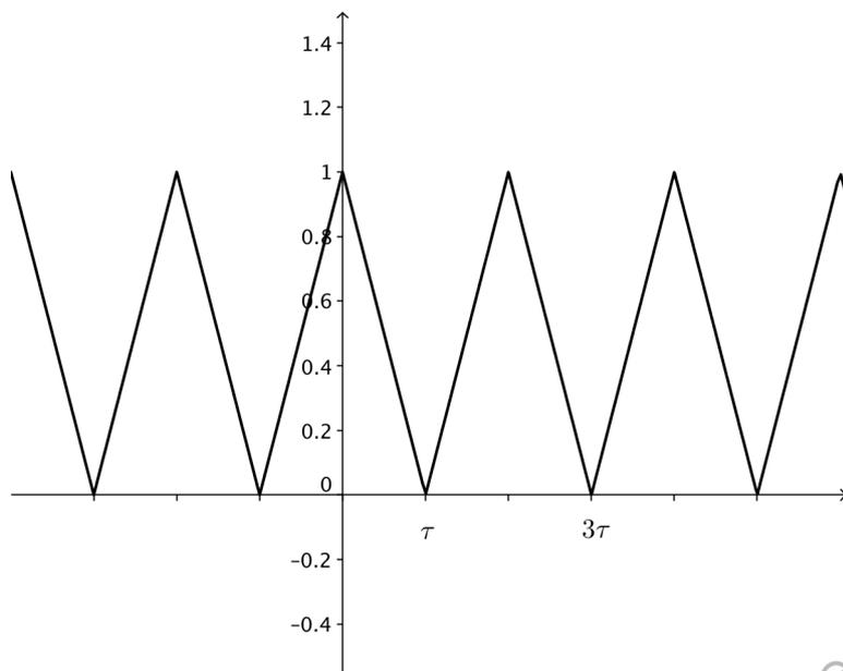
Ce signal est placé en entrée d'un filtre passe-bas (il s'agit d'un filtre de Butterworth d'ordre 6 et de fréquence de coupure 40 Hz).
